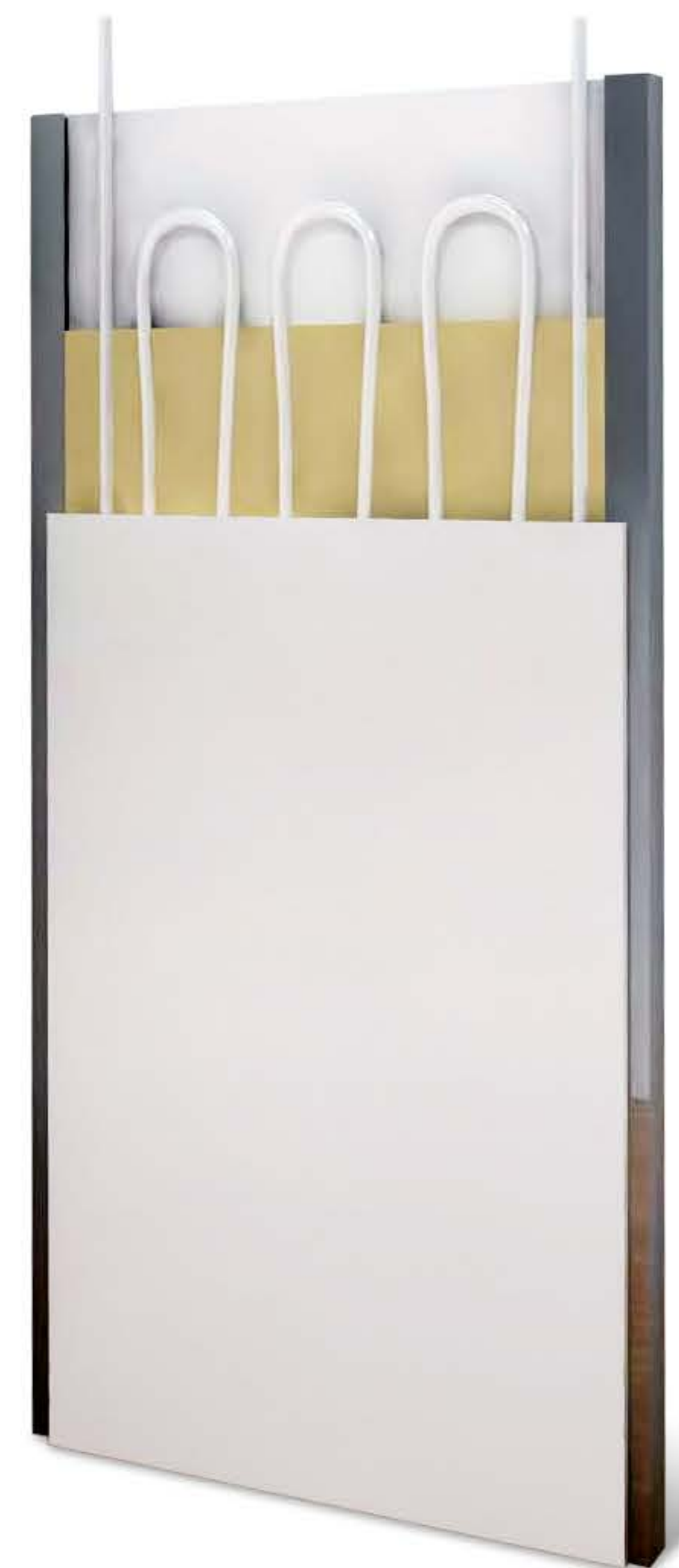
Sistema a parete e soffitto a secco Easy Kit Pex: costituito da moduli in lastra di cartongesso fresato con inserito tubo Pex e isolante EPS da 3 cm incollato. Moduli disponibili in varie misure.
